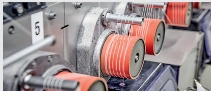
Durch einen Spulölauftrag und/oder einer Verwirbelung wird das Garn anschließend für die weitere Verarbeitung vorbereitet. Die Garne werden auf Hülsen gewickelt und als Spule für Folgeprozesse vorbereitet.
