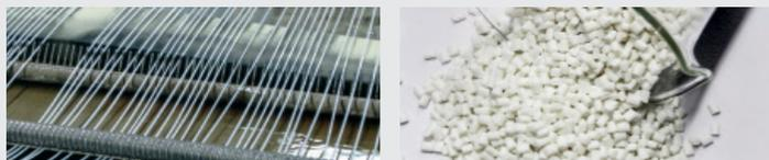
Hierbei reihen sich die einzelnen Monomere zu einer immer länger werdenden Kette aneinander. Diese Kettenstruktur wird über mehrere Reaktoren unter Zuhilfenahme von Druck, Temperatur über 270° C und Verwendung eines Katalysators gebildet.
