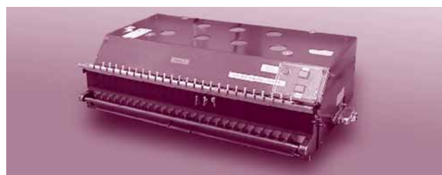
Con l'apparecchio KST viene effettuata una prova di abrasione sulle fibre.
