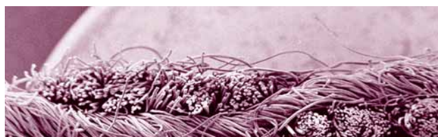
In Trevira Perform i piccoli grovigli di fibre si staccano impedendo la formazione del pilling.
